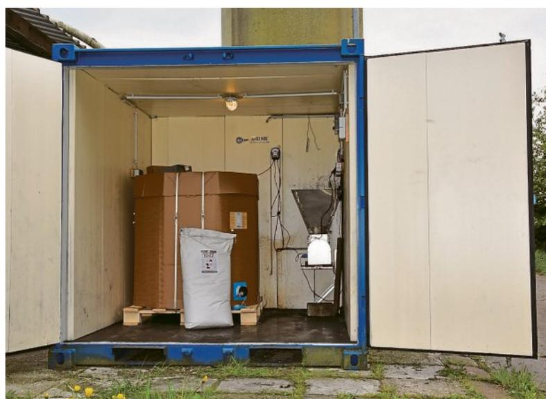
**In einem separaten Container direkt an den Futtersilos hat Jürgen Hemker die Dosieranlagen für den Kräuterextrakt und die Futterkohle untergebracht.**
